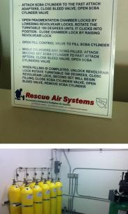
FIREFIGHTER AIR FILLING INSTRUCTIONS ADJUST FIREFIGHTER AIR REGULATOR TO DESIRED FILL PRESSURE
